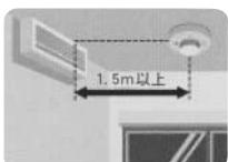
エアコンなどの吹き出し口がある場合は、吹き出し口から1.5m以上離して取り付けます。
