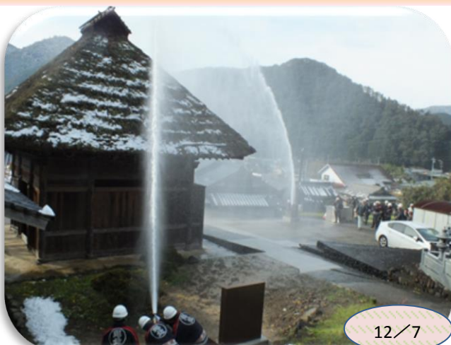
国指定文化財善光寺薬師堂自動式放水銃:消防団による実放水試験
