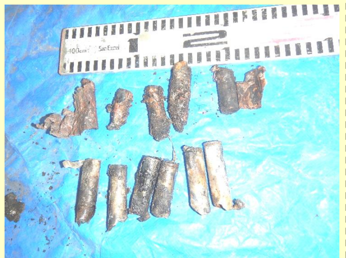
リチウムイオン電池の焼け跡 上が電池の中身 下が電池の外側ケース
